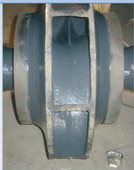
A felületi gödrök a járókeréken Loctite® Superior Metal epoxigyantával kerültek kijavításra, majd második rétegként Loctite® Nordbak® 7227 ecsetelhető kerámia került alkalmazásra
