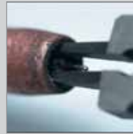
fúvóka belső és külső felszínén megtapadt szennyeződés eltávolítása
